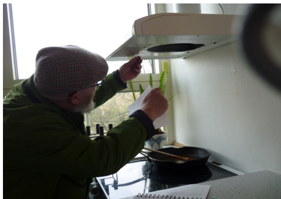
Foto 2: Emhætter tjækkes for sugsevne
